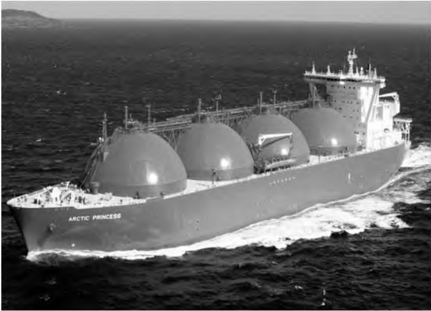
Figure 6-17 Moss type LNG tanker
